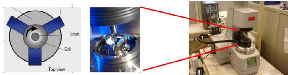
Abbildung 8: Tribo- messzelle (Anton Paar Physica MCR 501): Versuchsprin- zip und Bilder der Versuchsanordnung
