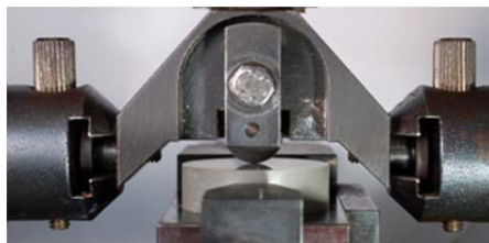
Abbildung 1: SRV-Prüfung: Links: Standardhalterung Rechts: Schema des modifizierten Aufbaus Stirnseite Ring gegen Stahlscheibe
